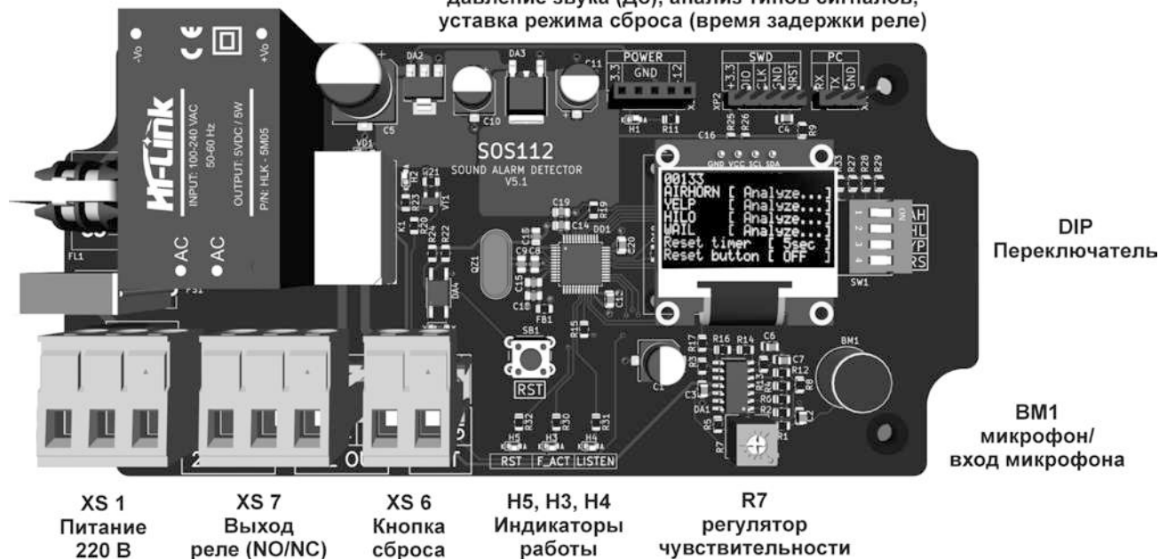
Рисунок 1 – Подключение и элементы настройки прибора
